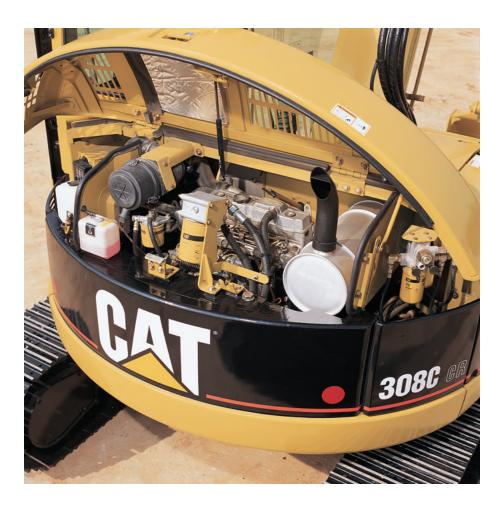
Sistema de enfriamiento. Dispone de un ventilador de gran diámetro y cilindros de longitud completa enfriados por agua que combinados con una eficiencia térmica excelente impiden el recalentamiento. El resultado es una mayor duración del motor y la capacidad de operar a altas temperaturas y bajo cargas pesadas. Dispone de un ventilador de flujo mixto que proporciona una alta eficiencia de enfriamiento. El radiador principal está equipado con aletas onduladas para impedir el atascamiento.
