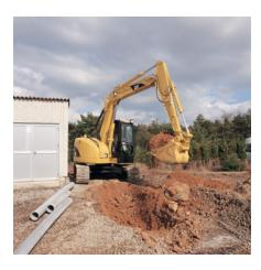
**Diseño de radio compacto.** La 308C CR es una versión de radio compacto de la 307C. Está diseñada para funcionar en un área de 2.850 mm (9 pies 8 pulg).
