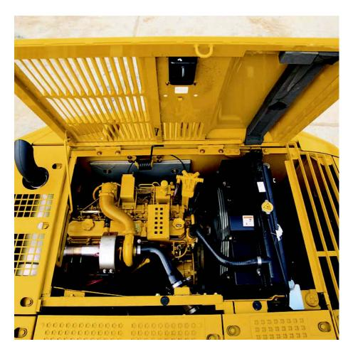
Reserva de par. El motor se ha diseñado para una alta reserva de par a rpm medias, una característica especialmente ventajosa para el uso en aplicaciones de servicio pesado. **Control automático del motor.** Este control de 3 etapas tiene un comando de un solo toque, maximiza el consumo de combustible y reduce los niveles de ruido.
