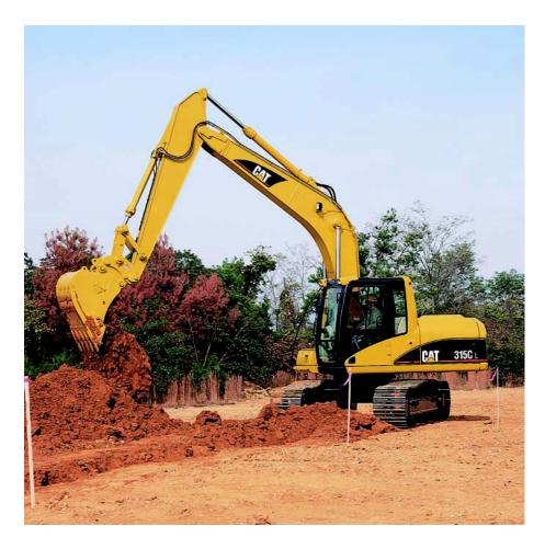
**Varillaje del cucharón.** El varillaje del cucharón de la 315C incluye el cilindro del cucharón, eslabón guía y los eslabones hidráulicos.
