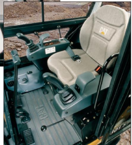
**Excelente visibilidad** del implemento gracias a ventanas grandes y al poste de rotación descentrado. El capó curvado y la gran zona acristalada trasera permiten una visibilidad excepcional de la parte trasera. Se obtiene una excelente ventilación de la cabina por medio de la ventana delantera fácil de abrir, la ventana delantera inferior removible y la ventana deslizante del lado derecho.
