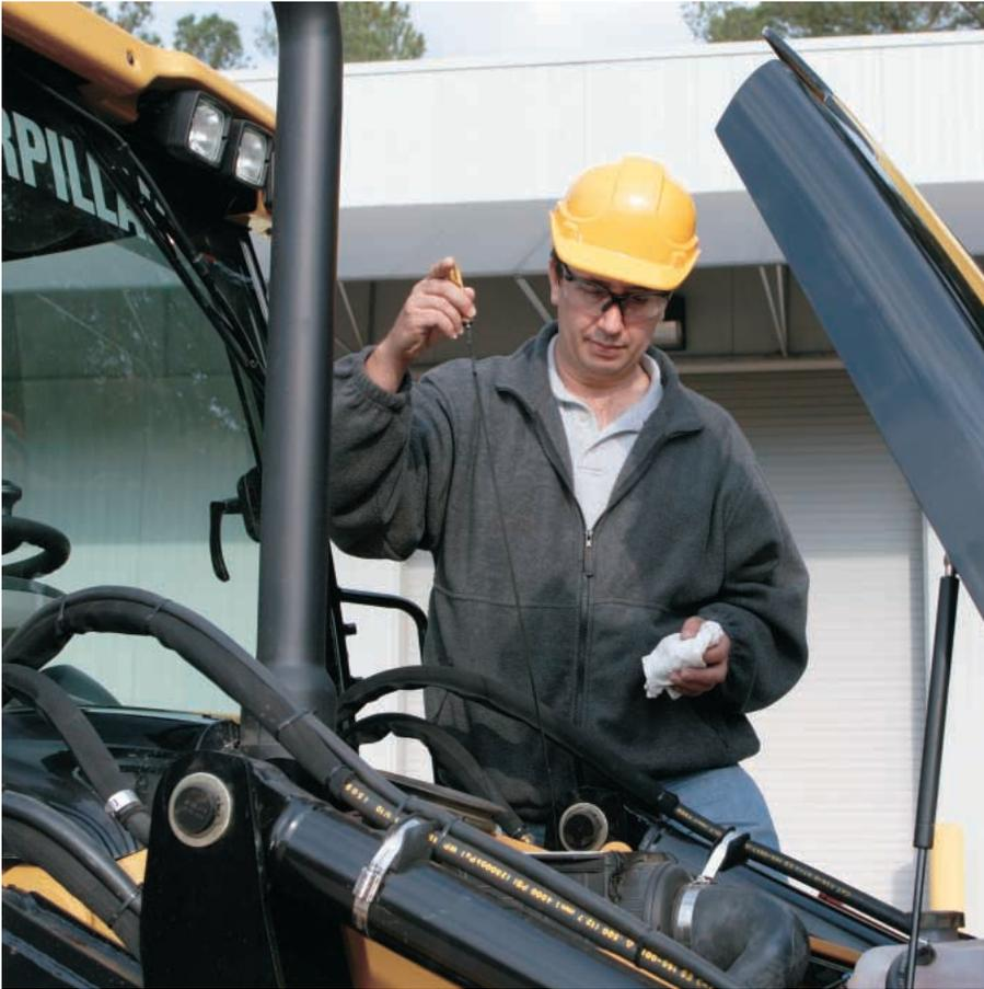
**Capó inclinable hacia arriba.** El capó inclinable hacia arriba permite un acceso fácil y cómodo a todos los puntos de revisión del motor desde el lado izquierdo de la máquina. Las tapas de llenado están codificadas con color para su rápida identificación.
