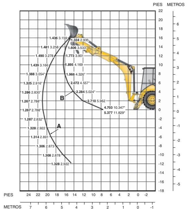
Las capacidades de levantamiento son valores sobre el extremo. Máquina equipada con tracción en las cuatro ruedas (4WD), OOPS, cucharón de uso general de 1,00 m<sup>3</sup> (1,31 yd<sup>3</sup>) y contrapeso de 116 kg (255 lb).
