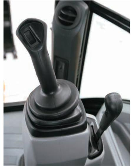
**Interruptores de rodillos de palanca universal.** Los rodillos de pulgar en la palanca universal proporcionan un control de funciones auxiliares muy cómodo que se acciona con el pulgar para características tales como el brazo extensible, los martillos y los sinfines. Los interruptores de rodillo eliminan la necesidad de los pedales, proporcionando espacio adicional para los pies del operador.
