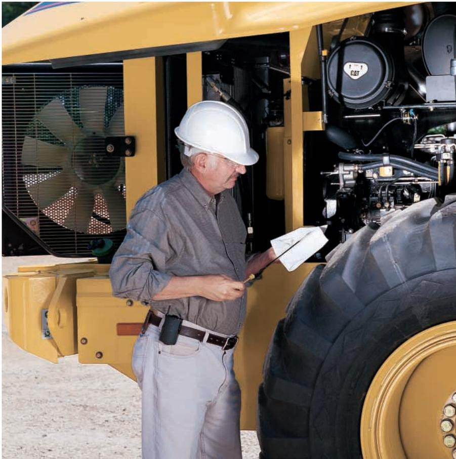
**Fácil acceso.** Las puertas tipo ala del recinto del motor, con levantamiento por cilindros de gas, permiten fácil acceso a los filtros y a los puntos de servicio. El radiador y los enfriadores de aceite son fácilmente accesibles para efectuar su limpieza.
