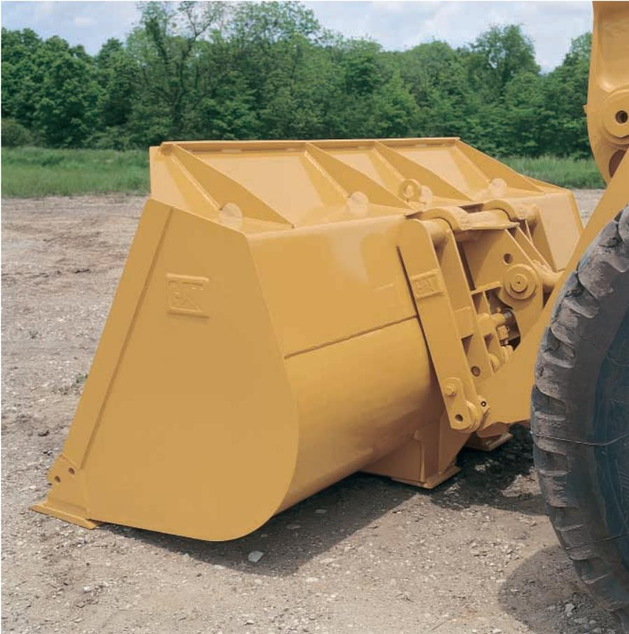
**Cucharones de uso general.** Trabajan bien en una amplia gama de aplicaciones incluyendo la excavación, el apilado y la explanación. Cucharón con costillas de refuerzo exteriores probado en la obra. Los cucharones de uso general (GP) pueden equiparse con dientes empernables o cuchillas empernables estándar de Caterpillar. Se ofrecen cuatro tamaños de cucharones básicos. Los cucharones son reconstruibles.
