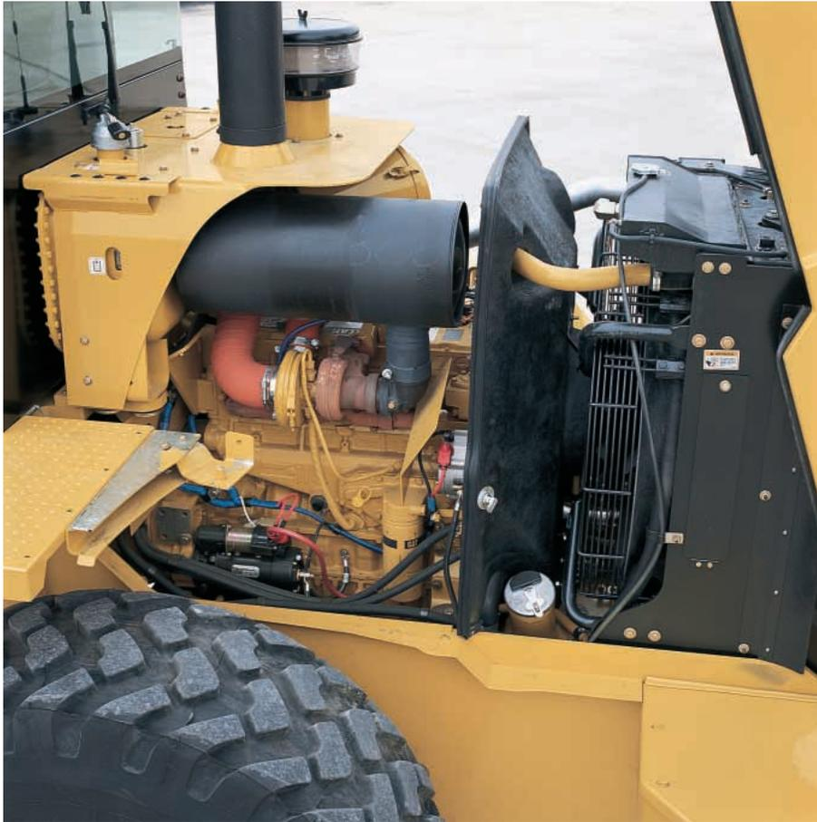
**Rendimiento poderoso.** El Motor 3126B ATAAC entrega una potencia neta de 119 kW (160 hp) y cumple con las normas de control de emisiones de Tier 2 de la EPA de EE.UU. El sistema avanzado mantiene el combustible a una presión baja en las tuberías de combustible hasta que se inyecte al cilindro. La presión del combustible se produce hidráulicamente, respondiendo a una señal del Módulo de Control Electrónico ADEM III™.
