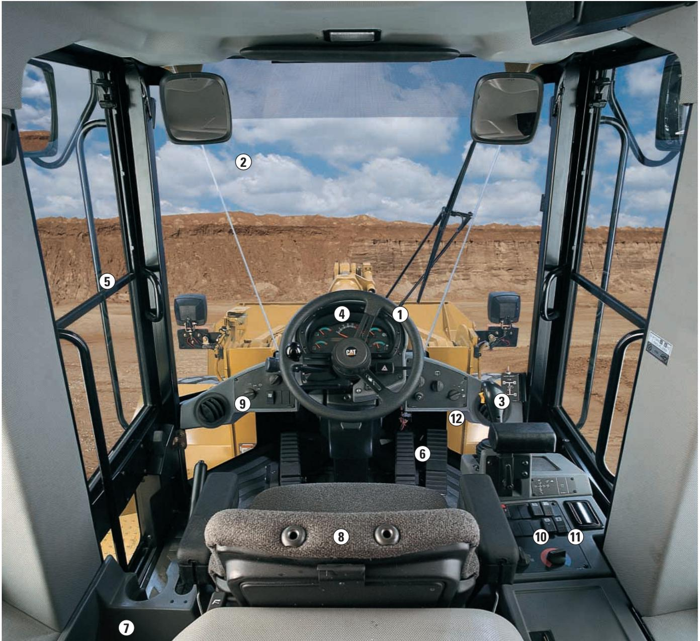
**1 Dirección.** Sistema de dirección de bajo esfuerzo con dosificación manual. La columna de dirección inclinable permite adaptar el volante al operador. La dirección con detección de carga transfiere potencia al sistema de dirección sólo cuando se necesite. Cuando no se use el sistema de dirección, se dispone de más potencia del motor para generar fuerza de arrastre en las ruedas, además de fuerza de desprendimiento y de levantamiento.
