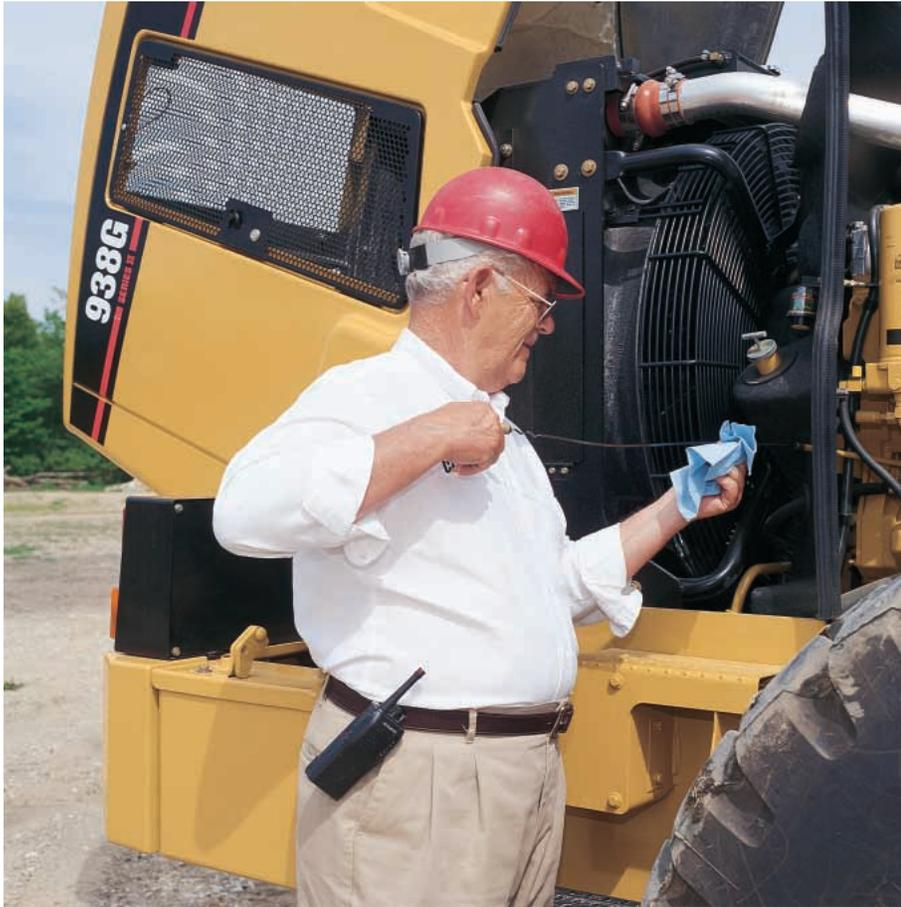
**Puntos de mantenimiento a nivel del terreno.** Todos los puntos de servicio, incluyendo los orificios de muestreo S•O•S, codificados por colores, se pueden alcanzar desde el suelo. Las tuberías de grasa remotas terminan en dos grupos de lubricación centrales en el área del enganche derecho.
