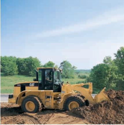
**Bajas emisiones de gases de escape.** El motor Cat 3126B ATAAC utilizado en las máquinas 938G Serie II es un motor de bajas emisiones diseñado para cumplir con los reglamentos de emisiones de Tier 2. Es de control electrónico, con posenfriamiento de aire a aire para una combustión más eficiente y emisiones más limpias.
