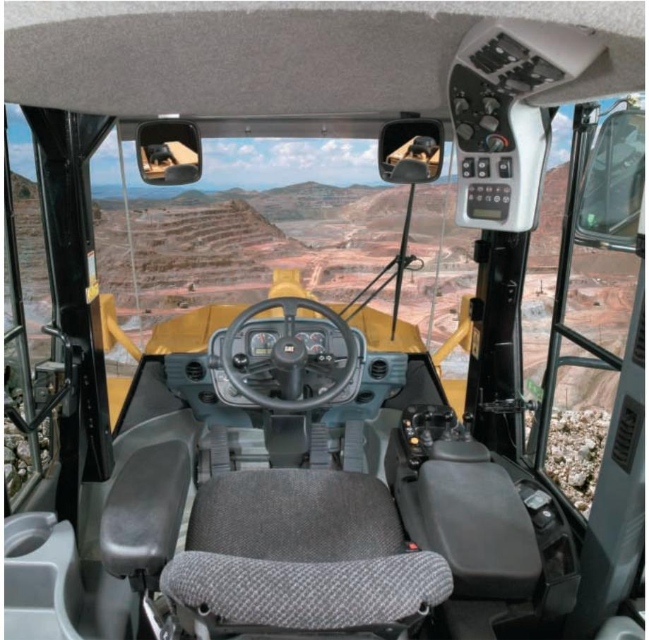
El volante Command Control contiene el interruptor de avance/neutral/retroceso y el botón de cambios ascendentes/descendentes – permitiendo que la mano izquierda permanezca en el volante en todo momento. Los controles del accesorio están integrados en el apoyabrazos derecho de modo que se mueven con el operador.
