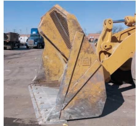
**Cucharones para rellenos sanitarios.** Los cucharones para rellenos sanitarios están diseñados para tener una larga vida útil en las condiciones más exigentes de las aplicaciones de basuras. Este cucharón de alta capacidad está bien adaptado para cargar, clasificar y otros trabajos de una estación de transferencia.
