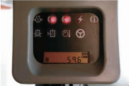
**Sistema Monitor Caterpillar.** El Sistema Monitor Caterpillar (CMS) hace el seguimiento de los sistemas críticos de la máquina para alertar al operador de la necesidad potencial de servicio. Existen cuatro niveles de advertencia que permiten al operador evaluar la situación con mayor exactitud.
