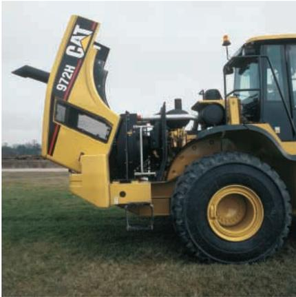
**ACCESO AL COMPARTIMIENTO DEL MOTOR.** El capó no metálico del 972H se ha cambiado de diseño y estilo con respecto a los modelos anteriores. Los paneles laterales y superior son más fuertes debido a las nervaduras de refuerzo más robustas – el cambio de perfil también confiere rigidez al capó.
