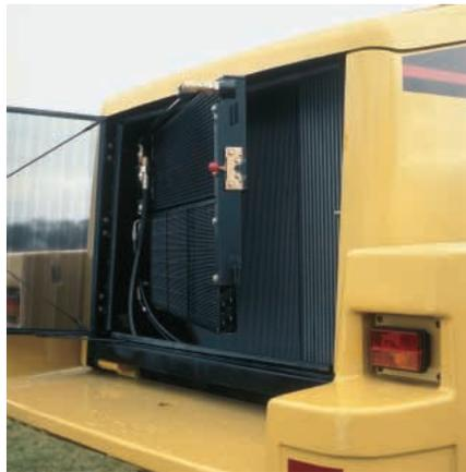
**SISTEMA DE ENFRIAMIENTO.** El acceso al sistema de enfriamiento para la limpieza y el mantenimiento es extraordinario. La parrilla perforada y corrugada reduce al mínimo la acumulación de residuos y se abre hacia afuera para facilitar la limpieza y el acceso de los núcleos de enfriamiento.
