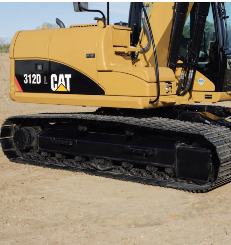
Caterpillar utiliza métodos avanzados de ingeniería y software para analizar todas las estructuras, creando una máquina fiable y duradera para las aplicaciones más rigurosas. Más del 70 por ciento de las soldaduras estructurales son realizadas con tecnología robótica y alcanzan una penetración adicional que supera las soldaduras manuales. Estos componentes estructurales y el tren de rodaje son la espina dorsal de la durabilidad de la máquina.
