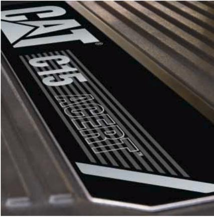
**Motor diesel.** El C15 de Caterpillar con tecnología ACERT es un motor de 15,2 litros, seis cilindros, de 302 kW (404 hp) con inyección electrónica de combustible mecánicamente accionada (MEUI) y árbol de levas en culata. La tecnología ACERT provee rendimiento sobresaliente del motor mediante el control electrónico avanzado, entrega precisa de combustible, y administración perfeccionada de aire.
