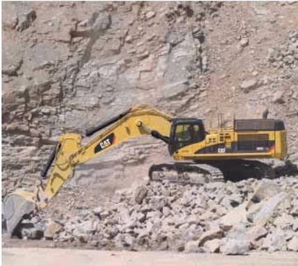
**Hidráulica PPPC.** El sistema sensor de carga con compensación proporcional de prioridad de presión (PPPT), con accionamiento electrónico desarrollado por Caterpillar provee alta eficiencia y excelente controlabilidad.
