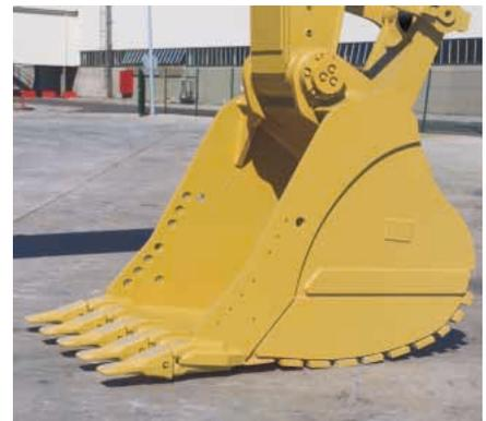
**Herramientas de corte.** Las herramientas de corte Caterpillar incluyen una variedad de orejetas, protectores de barra lateral, opciones de punta para adaptarse a las condiciones de operación.
