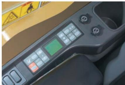
**Consolas.** Hay consolas que disponen de un nuevo diseño sencillo y funcional para reducir la fatiga del operador, facilitar la operación del interruptor y proveer una visibilidad excelente. Ambas consolas tienen posabrazos fijados que permiten ajustar la altura de los posabrazos.
