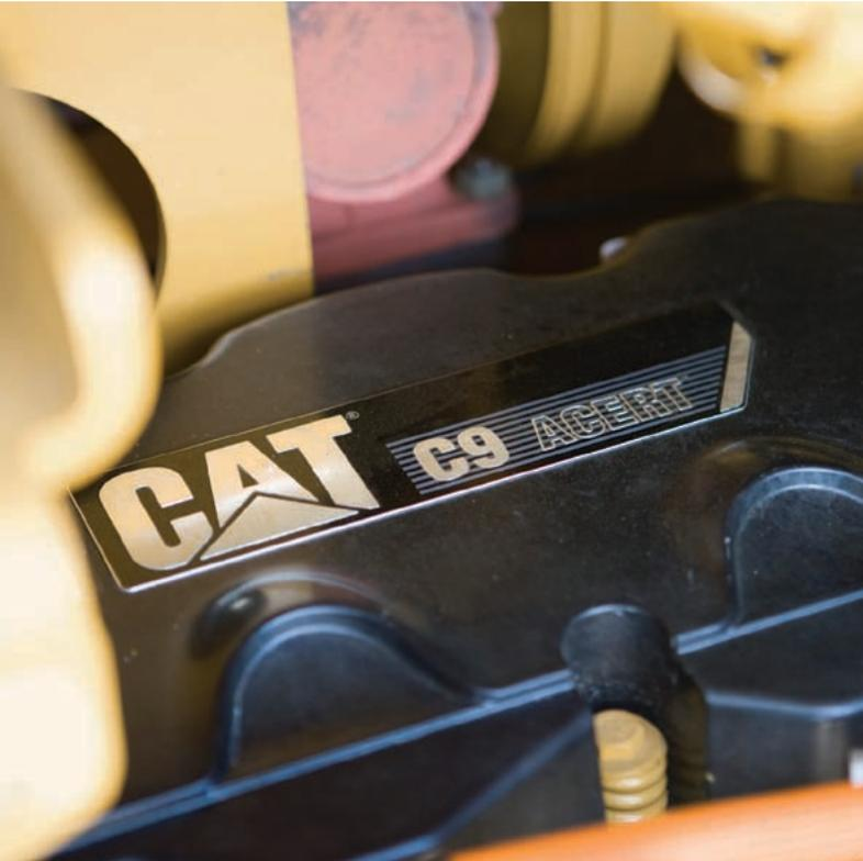
El tren de fuerza eléctrico del D7E funciona con el motor Cat C9.3 de 235 hp con tecnología ACERT™. El motor utiliza un sistema de combustible de riel común para una mayor eficacia y un ahorro de combustible. Con las últimas tecnologías de reducción de emisiones de Cat, este motor cumple con los estándares de regulación de emisiones EPA Tier 3 (EE. UU.), Fase IIIa (Europa) y MLIT Paso 3 (Japón).
