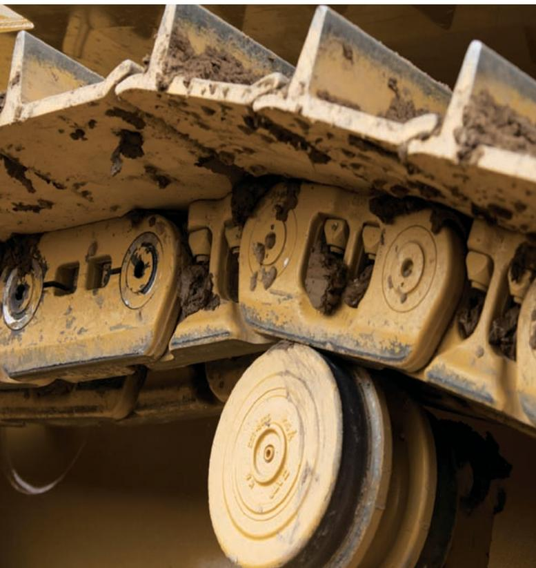
El D7E ofrece un diseño de tren de rodaje de accionamiento secundario avanzado para una mayor versatilidad de la máquina en una gran variedad de aplicaciones. La visibilidad mejorada, especialmente en los laterales, es sólo una de las diferentes ventajas de este sistema de tren de rodaje tan eficiente.
