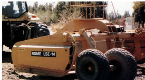
Niveladoras de terreno con sistema de eyección
